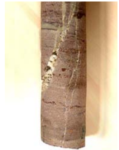
Ein Bohrkern aus dem Buntsandstein von Soultz mit natürlichen Klüften, die teilweise mit Ablagerungen aus Baryt (Bariumsulfat) zugesetzt sind.
