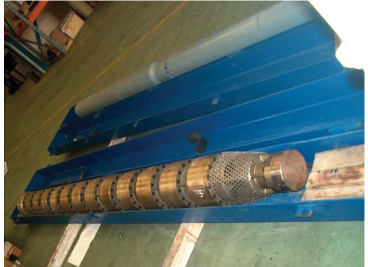
Abbildung 11: Zwölfstufige Tiefpumpe vor Anlieferung in Unterhaching
